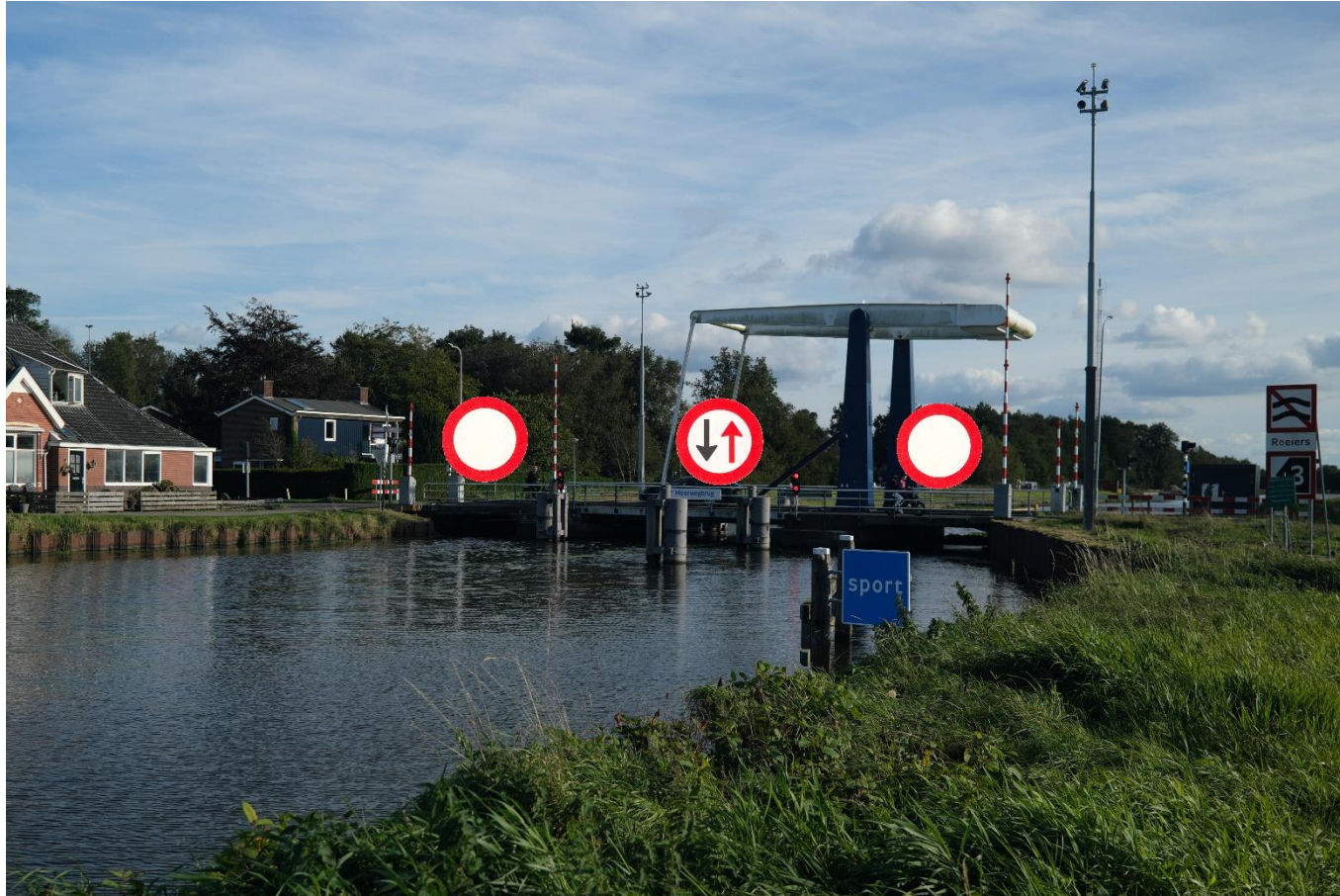
Afbeelding 14 Meerwegbrug; niet doorvaren, ongeacht de vaarrichting. Middelste bruggat: verleen voorrang aan roeiers die naderen op een tegengestelde koers. Rechterbruggat: niet doorvaren, ongeacht de vaarrichting.
